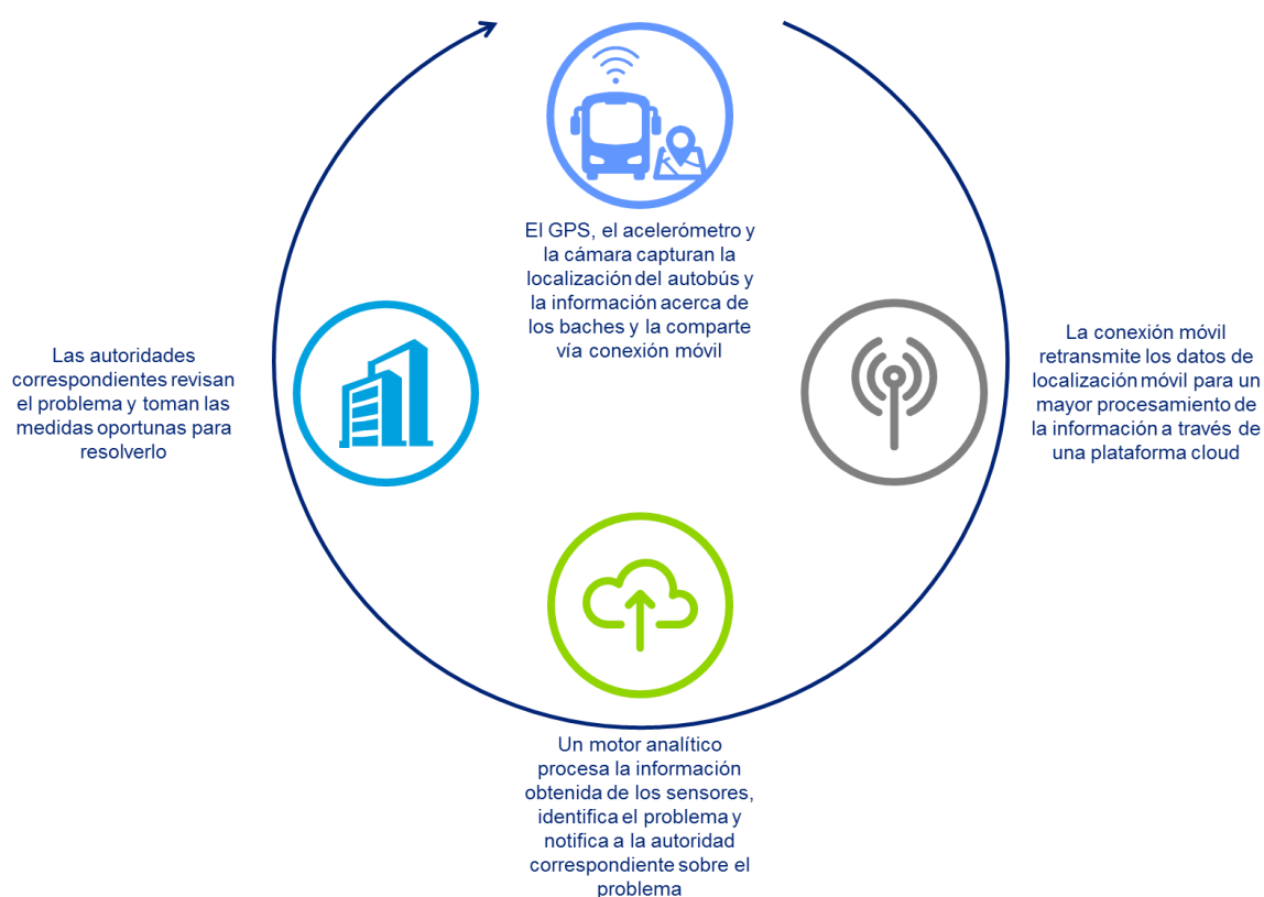
Figura 104. Detección de daños en la carretera
